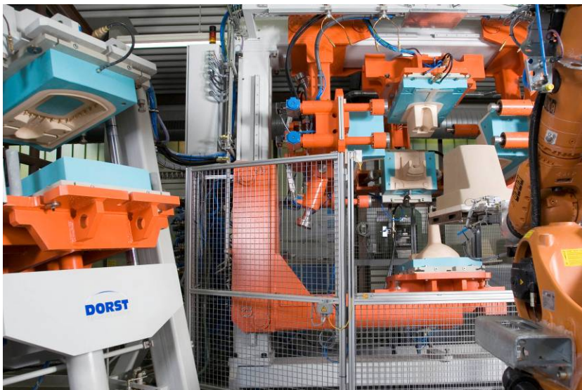
Bild 1: Anlage für die Herstellung eines Bauteils nach dem Schlickerdruckgießverfahren [Quelle: Dorst] 1
