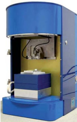
Abb. 2: Mikrotribologische Messapparatur Tetra Basalt MUST. Das Kontaktpaar besteht aus einer ventralen Schuppe einer Exuvie sowie einer glatten Glaskugel ( R_a=0,006 \mu\text{m} , \square 1\text{mm} ).
